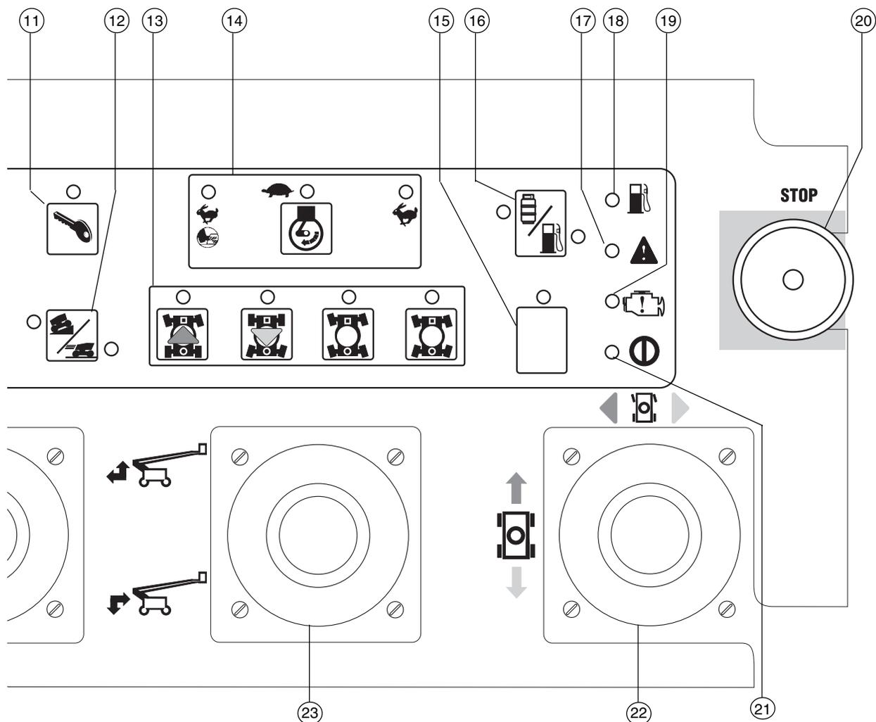
15 Lâmpada indicadora de sobrecarga da plataforma (se instalada)
