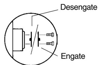
Modelos 4WD: libere os freios das rodas, virando as quatro tampas de desconexão do cubo de tração.
